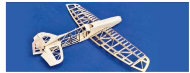
Zum ersten Mal sind alle Baugruppen provisorisch zusammengesteckt. Der Wiesel ist eine formschöne Konstruktion mit eigenständigem Erscheinungsbild. Bei diesem Bau habe ich noch geschnittene, gesägte und gelaserte Teile verwendet. Ein zweiter Wiesel soll nur aus gelaserten Teilen entstehen
